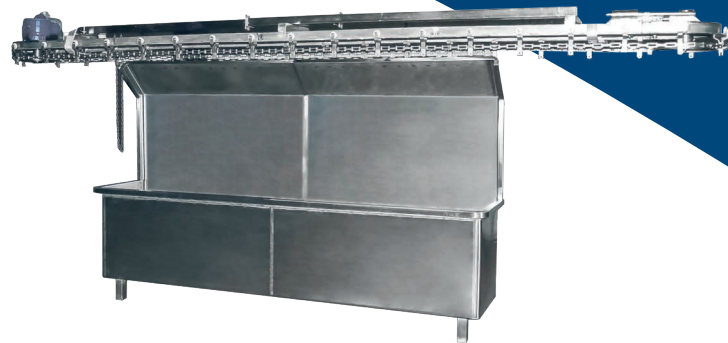
⚙️ NORIA PARA TRANSPORTE DE CABEZAS CON GABINETE DE LAVADO
