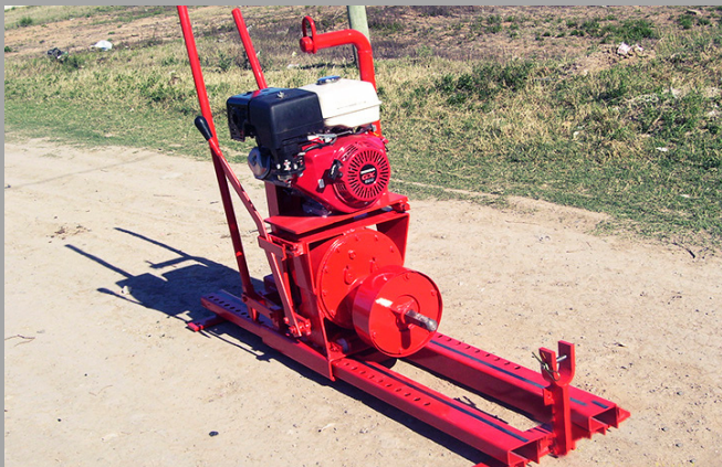
TME 12 TUNELERA CON MOTOR A EXPLOSIÓN HONDA DE 13HP CON CAPACIDAD DE HASTA 0,30m DE DIAM. POR HASTA 20ML DE LARGO
