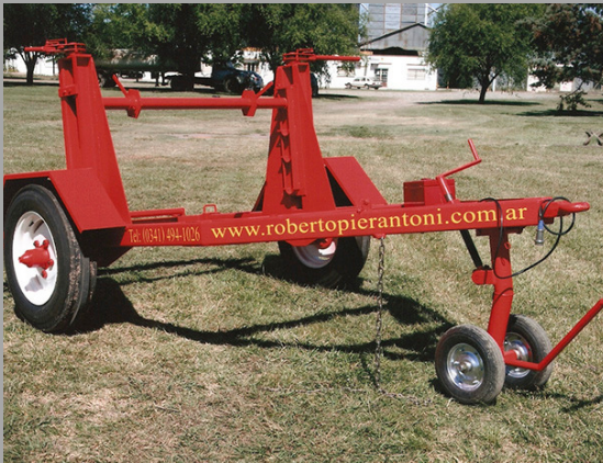
CPA 500 CARRETON PORTAROLLOS TRITUBO, AUTO CARGABLE, CON CAPACIDAD DE HASTA 500 KG
