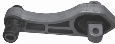
Código: 50201 Modelo: QUBO-FIORINO QUBO N° Original: 51805434 Soporte de motor trasero
