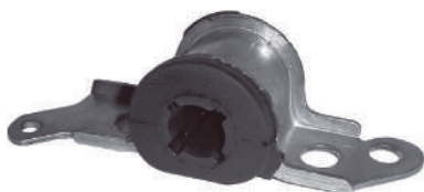
Código: 50146 Modelo: FIAT PALIO - SIENA (Base) Nº Original: 46450462 Soporte punta de parrilla derecho
