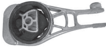
Código: 40084 Modelo: PRISMA -SPIN-ONIX-SONIC-COBALT Nº Original: 95493722 Soporte trasero de motor
