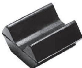
Código: 50008 Modelo: FIAT 600 Nº Original: 991591 Soporte de elástico delantero
