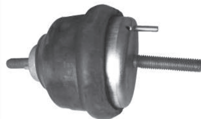
Código: 70162 NO HIDRAULICO Modelo: TRANSIT Nº Original: 95BVB-6B032-BA Soporte motor no hidráulico lado izquierdo
