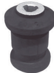
Código: 50190 Modelo: QUBO LINEA Nº Original: 51811977 Buje parrilla suspensión delantera
