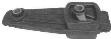
Código: 20007 Modelo: C3 Nafta / Diesel Nº Original: 180659 Bieleta antipar
