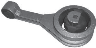
Código: 70144 Modelo: FIESTA Nº Original: XS61-6P082-AA Soporte de motor central
