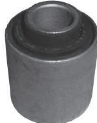
Código: 60082 Modelo: 504 - 505 Nº Original: 3523-160 Buje brazo oscilante delantero Ø 33 mm
