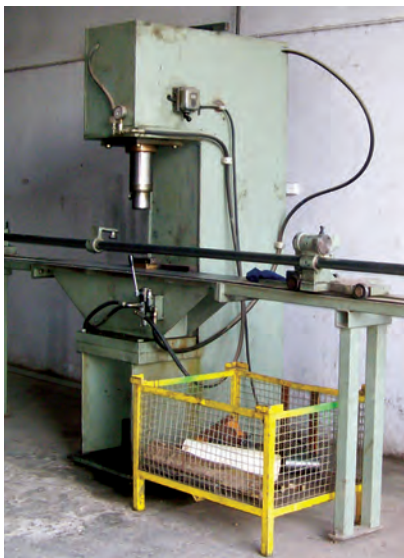
PRENSA ENDEREZADORA EITEL PRESSES RP40, 380V SERIE 25188 Con bancal de desplazamiento
