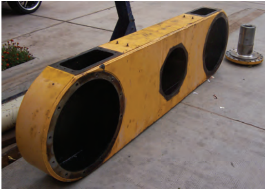
REPARACIÓN DE CAJA PUENTE
