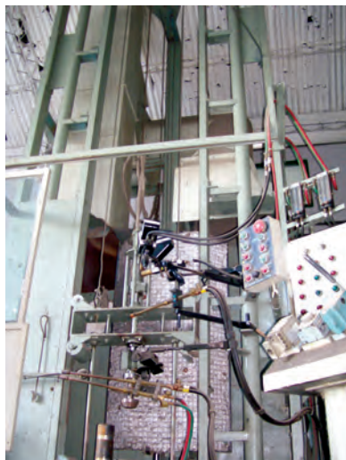
EQUIPO PARA METALIZADO VERTICAL Con pistolas METCO
