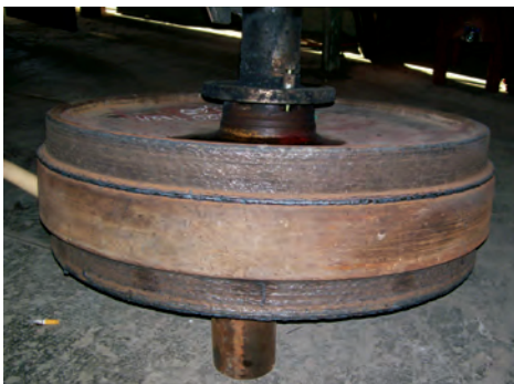
APORTE CON SOLDADURA PARA RELLENO DE GUÍAS DESGASTADAS
