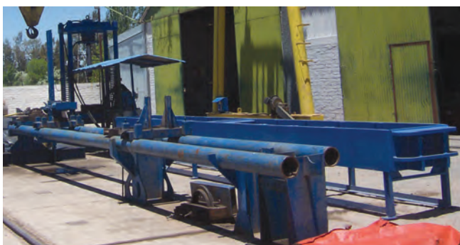
BANCO PARA ARMADO DE CILINDRO HIDRÁULICO Y PARA PRUEBA HIDRÁULICA DE CILINDROS HIDRÁULICOS
